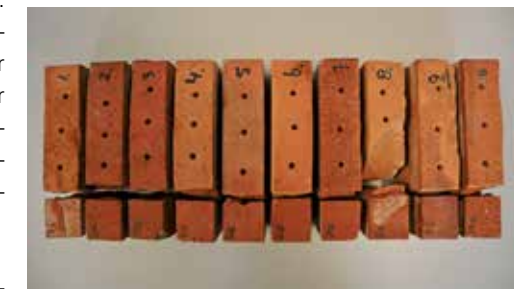
Figur 1. Sten udtaget i forbindelse med besigtigelse af boligbebyggelse fra perioden. Ud fra farven kan stenenes brændingsgrad bedømmes, og brændingstemperaturen bedømmes til at have varieret mellem ca. 850 og ca. 1050 °C. Nederst ses afhugget del af hver enkelt sten, som er genbrændt ved 1030°C. Der ses markante svind ved genbrænding, hvilket viser, at de lyseste sten har været brændt ved meget lav temperatur.
